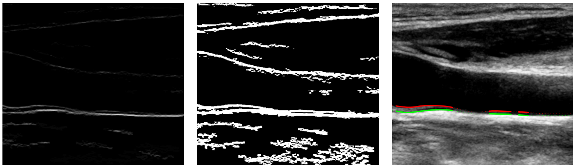
Figura 3.25. – Gradiente de la imagen #57 empleado para validación por intensidad (izq), salida del clasificador K-means de dos clases (centro) y resultado de la validación basada en intensidad sobre la imagen recortada (der).
